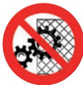
■ Es ist strengstens verboten, **Schutzabdeckungen und Sicherheitseinrichtungen** an Maschinen und Anlagen zu entfernen oder zu manipulieren.
